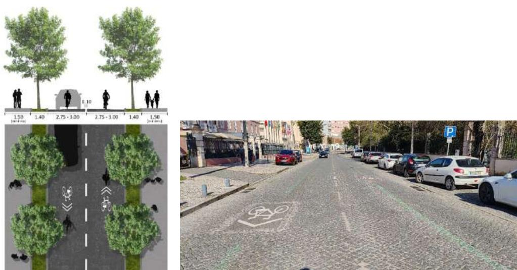
Figura 17. Perfil-tipo de canal partilhado com o automóvel e imagem de referência
